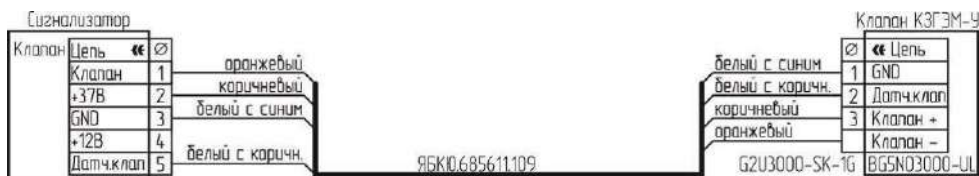
Рисунок Б.4 – Схема подключения клапана КЗГЭМ-У с разъемом BG5NO3000-UL.
